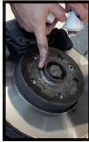
**11** Die neuen, längeren Befestigungsmittel auf Länge und Typ prüfen, vgl. umseitige Schraubhinweise. Die neuen Radbefestigungsmittel müssen um Scheibenstärke länger als die ursprünglichen Befestigungsmittel sein. Check if the length and type of seating of the new and longer bolts are correct. (Have a look overleaf at the bolts advice. The new fixings need to be as long as the originals plus the thickness of the spacer.
